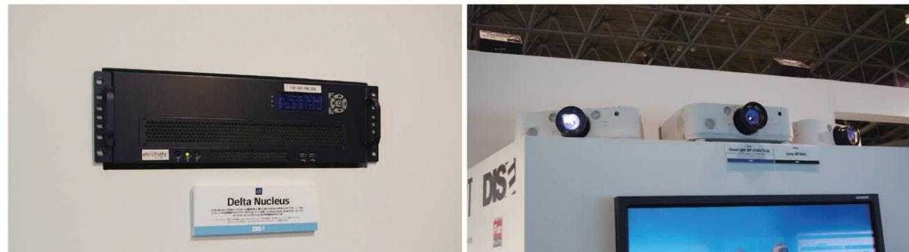
▲ ブース内に設置された「Dome Projection」では、NEC社のプロジェクター「ViewLight NP-PA621UJL」(右下)を3台使用。メディアサーバーは7thSense Design社の「Delta Nucleus」(左下)を採用している。なお、スクリーンには、プロジェクション専用開発された、反射効率の高いアクリル成分のコーティング「screen goo」が塗装されており、投影されたコンテンツの明るさはプロジェクター本来のスペックを超えるものとなっていた。
